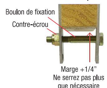
Boulon fixé sous la membrure supérieure
